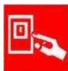
INTERRUTTORE GENERALE DELL'IMPIANTO
